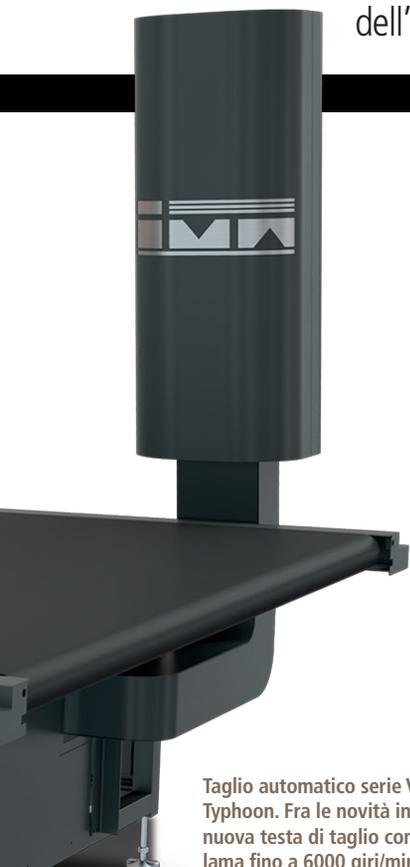
Taglio automatico serie Vortex modello Typhoon. Fra le novità in mostra: una nuova testa di taglio con velocità della lama fino a 6000 giri/min, masse contro rotanti per ridurre al minimo le vibrazioni, sensori di sforzo lama per ottenere elevata qualità di taglio, valvole proporzionali per il comando dei cilindri pneumatici
