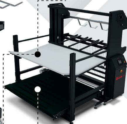
piano inferiore a conveyor per carico pezze.
