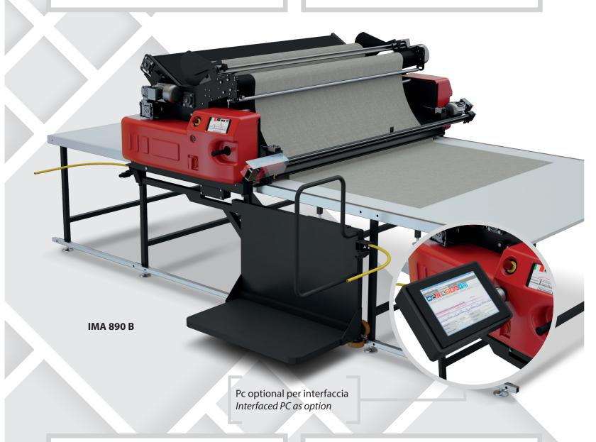
**IMA890B** ha la possibilità di impostare su touch screen la velocità di stesura e di ritorno a vuoto, 30 diverse rampe di accelerazione (per stesura con e senza pinze) per un numero complessivo di set up molto elevato.
