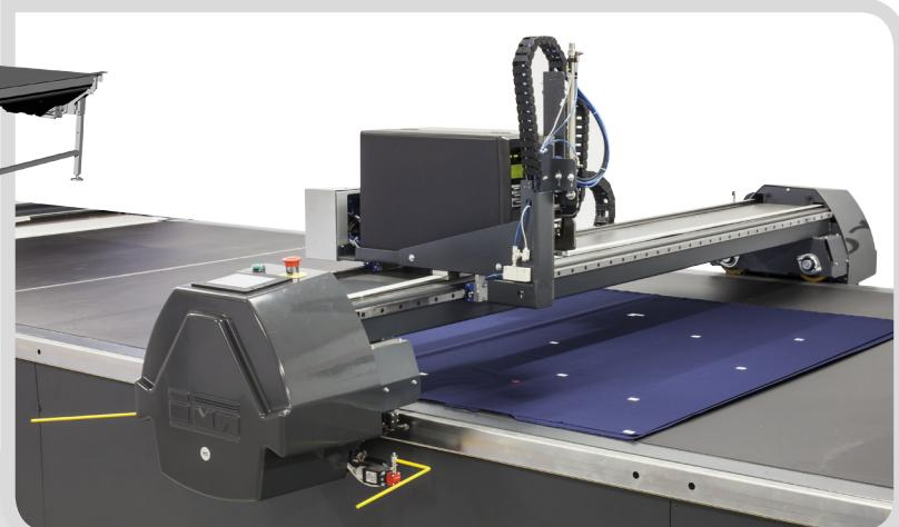
Il sistema applica automaticamente le etichette adesive sul telo superiore del materasso, riportando le informazioni necessarie al riconoscimento delle parti del modello e del lotto.
