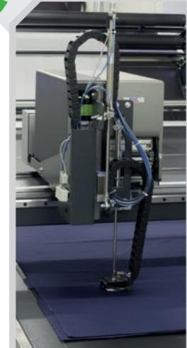
Il sistema applica automaticamente le etichette adesive sull'alto del materasso, riportando le informazioni necessarie al riconoscimento delle parti del modello e del lotto.
