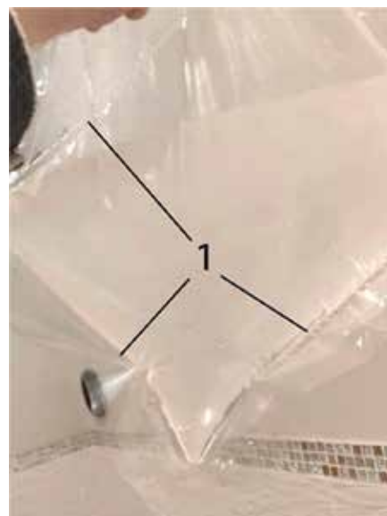
Рис. 7. Изготовленный с помощью сплошного сварной ролика в 4 мм ТПУ пакет. 1 – сварной шов.
