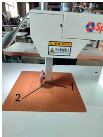
Рис. 6. Общий вид: машина ультразвуковая Масри EU-131; 1 – ролик 4 мм; 2 – волновод, место сваривания материала
