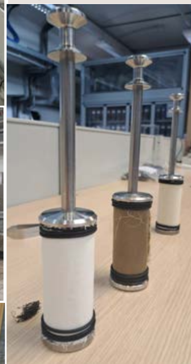
[sopra] Prove di tintura su campioni di tessuto nel laboratorio chimico
