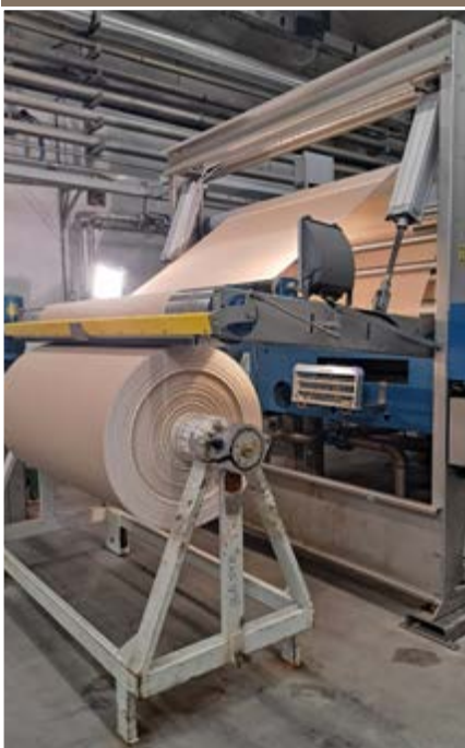
[sopra] Il tessuto arriva in produzione appena uscito dal telaio, con una colorazione naturale beige, e viene lavato e candeggiato
