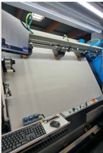
3 macchinari completamente automatizzati, dotati di AI e telecamere ad alta risoluzione, effettuano il controllo qualità finale analizzando il tessuto in continuo, alla ricerca di difetti e anomalie
