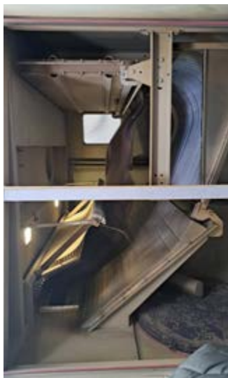
La tecnologia Flower Air spinge il tessuto contro una parete con un potente getto di aria calda (fino a 110°), massaggiandolo e conferendogli una mano morbida
