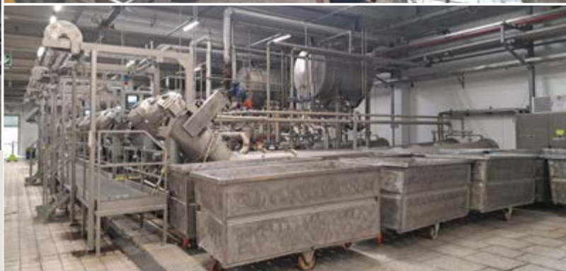
[sopra] Il tessuto arriva in produzione appena uscito dal telaio, con una colorazione naturale beige, e viene lavato e candeggiato
