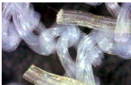
4: Danneggiamento da cloro
