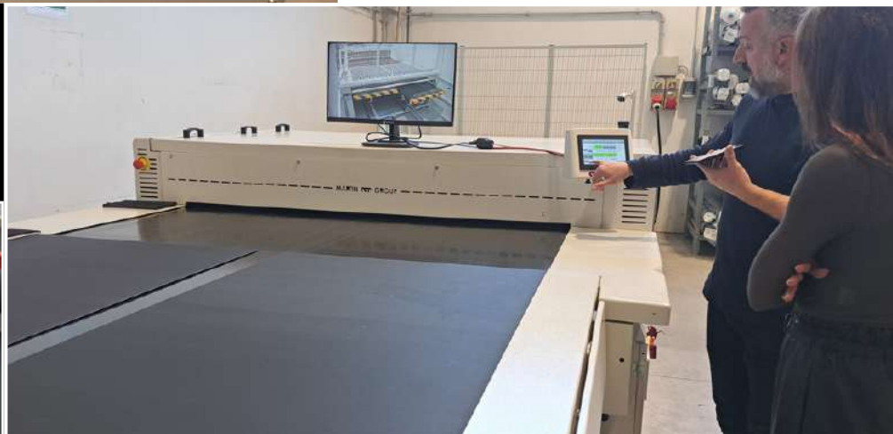
La macchina adesivatrice a rullo continuo a due piste a freddo X1600KEL-OT di Martin Group (7-8m) installata presso SerAlfred
