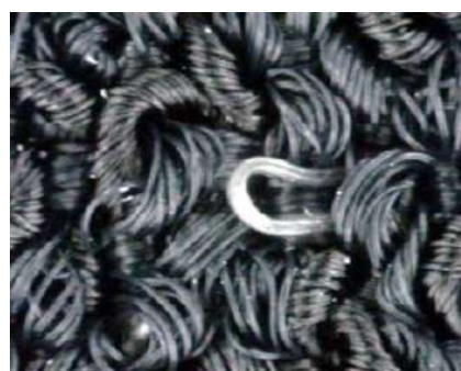
1A+1B: Boccole/anelli fuoriuscenti
