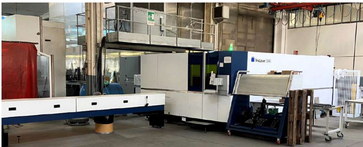
La nuova macchina per il taglio laser della lamiera è dotata di mandrino per poter essere trasformata in una macchina taglia tubo
