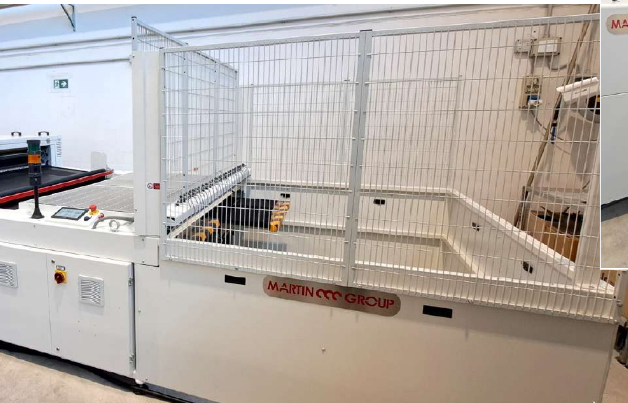
La macchina adesivatrice a rullo continuo a due piste a freddo X1600KEL-OT di Martin Group (7-8m) installata presso SerAlfred
