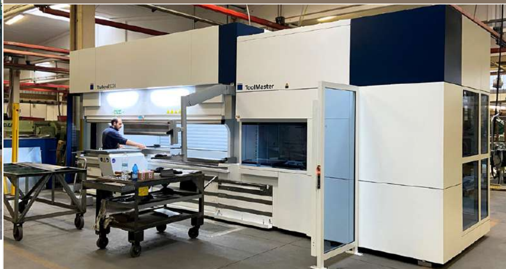
La nuova piegatrice è asservita da un sistema di attrezzaggio automatico che riduce tempi e fatica rispetto alla procedura manuale
